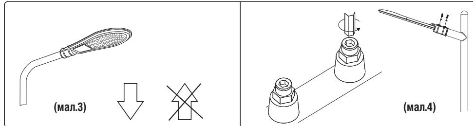
Розсіювач виробу обов'язково повинен бути спрямований донизу. Встановлення ліхтаря в протилежному положенні не допускається (mal.3). Монтаж має виконуватися так, щоб корпус ліхтаря не був нічим накритий. В іншому випадку буде порушений тепловідвід і виріб вийде з ладу.
